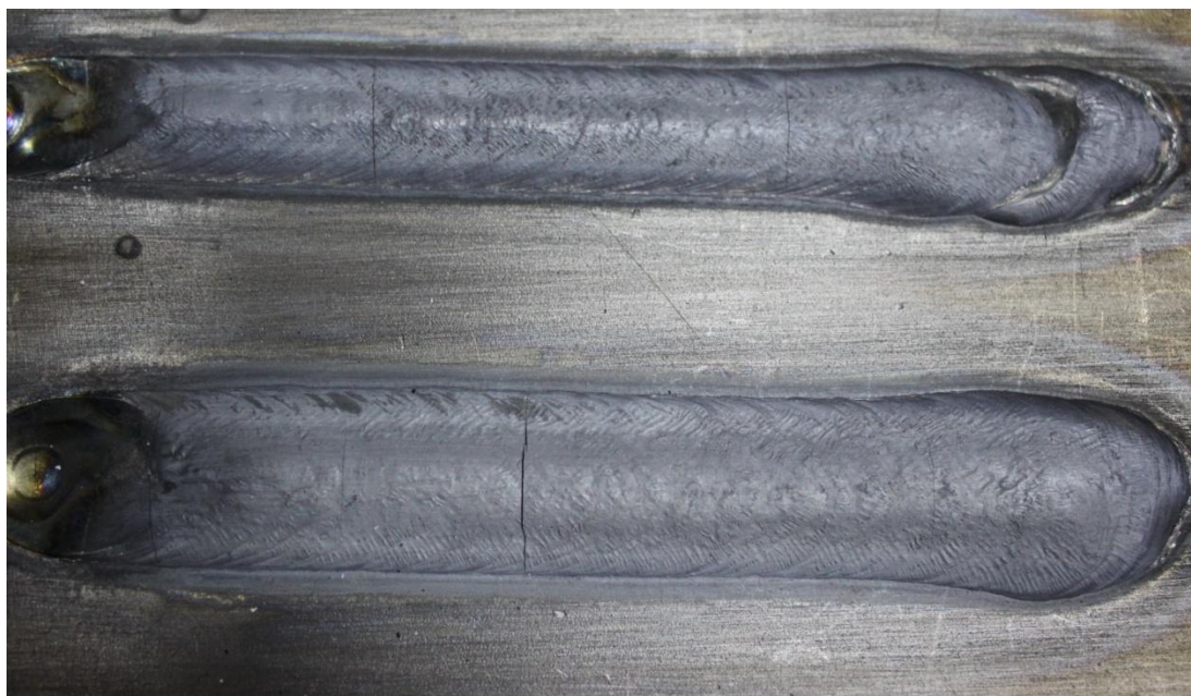
Рисунок 3.7. Внешний вид наплавленного валика с подогревом со скоростью подачи присадочной проволоки 2 и 3 м/мин
