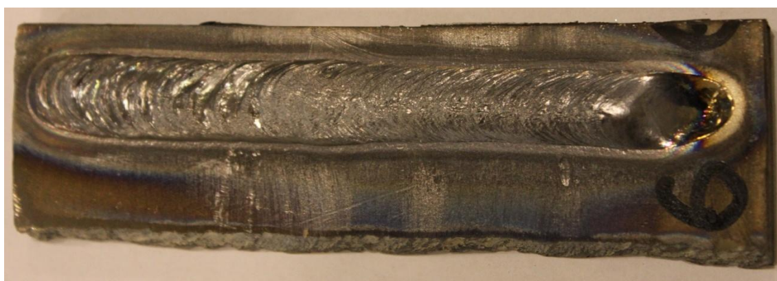
Рисунок 3.1. Внешний вид наплавленного валика с подогревом со скоростью подачи присадочной проволоки 2 м/мин
