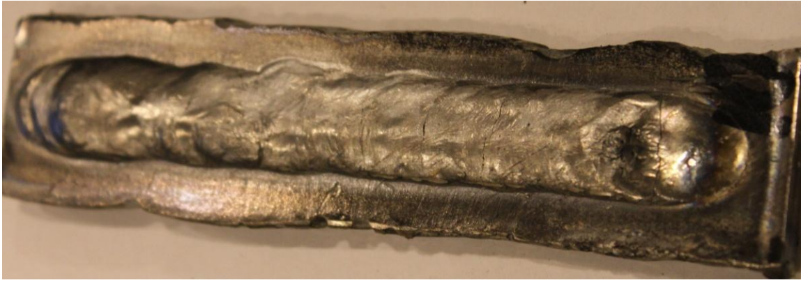
Рисунок 3.2. Внешний вид наплавленного валика с подогревом со скоростью подачи присадочной проволоки 6 м/мин
