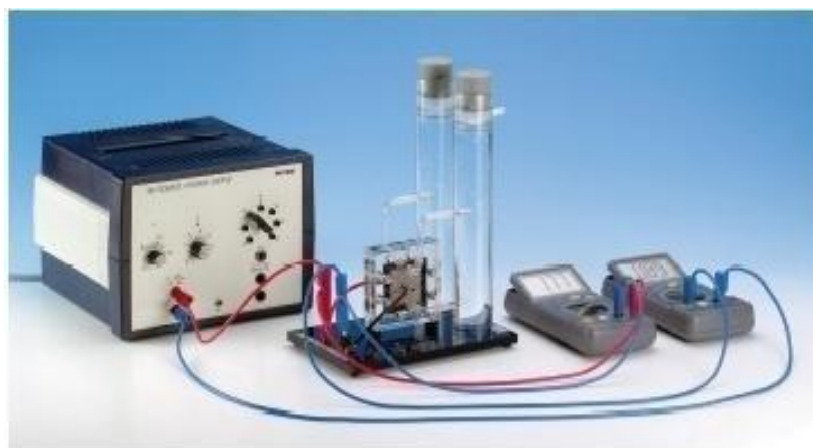
Рисунок 2.3 – Лабораторная установка для получения водорода при помощи электролизера, работающего от генератора
