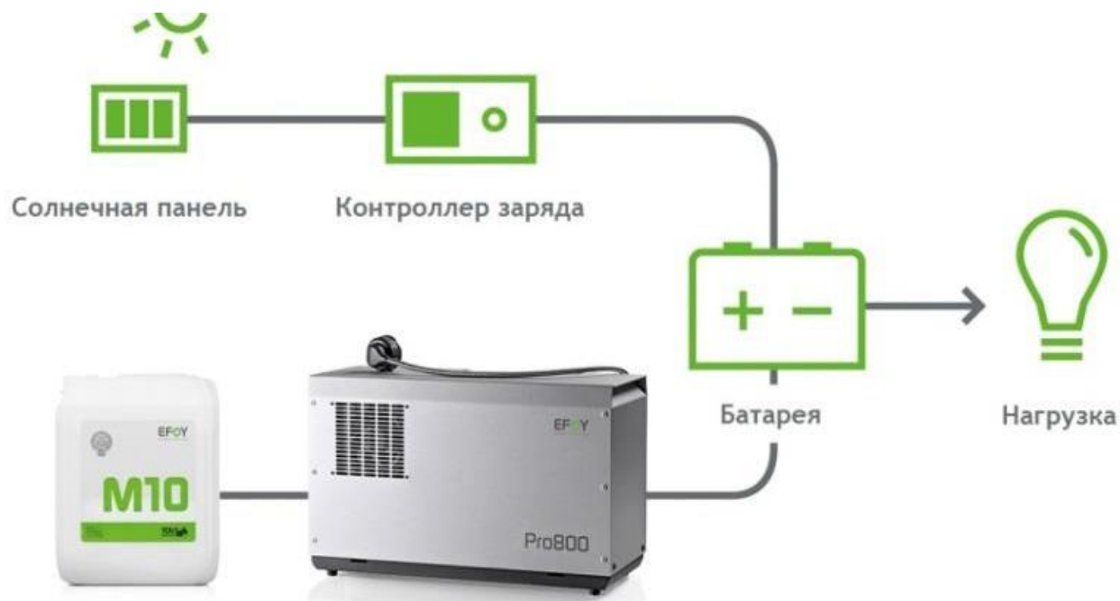
Рисунок А1 - Пример реализации автономного обеспечения на базе топливных элементов
