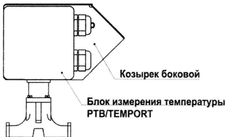
Рисунок 3.2.9 – Коробка, оборудованная датчиком, измеряющим температуру воздуха
