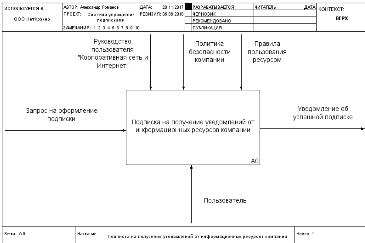
Рисунок 1.2 – Контекстная IDEF0-диаграмма бизнес-процесса подписки на получение уведомлений от информационных ресурсов компании КАК ЕСТЬ (0-й уровень)
