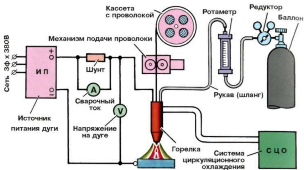
Рисунок 2.4 – Схема сварки в среде защитного газа с использованием электродной проволоки
