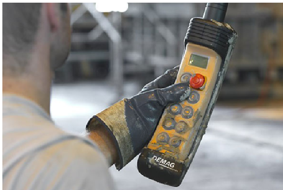
Рисунок 4.3 – Пульт управления кран-балкой
