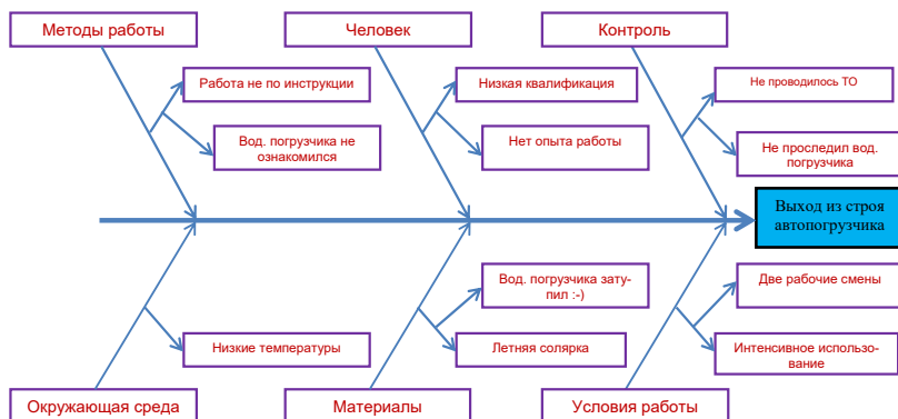
Рис. 9. Диаграмма Исикавы для выявления проблемы выхода из строя автопогрузчика
