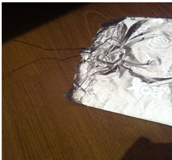
Фото 3.4 Проводник «алюминиевая фольга» длиной до 10м
