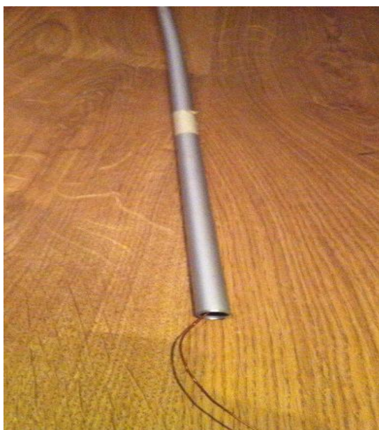
Фото 3.3 Проводник «алюминиевая трубка» длиной 1м
