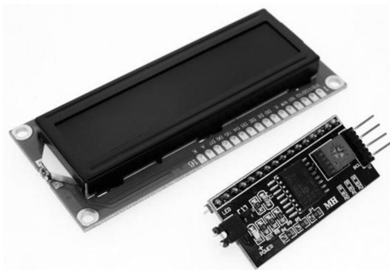
Рисунок 2.8 – Дисплей LCD1602 и плата подключения I2C-интерфейса
