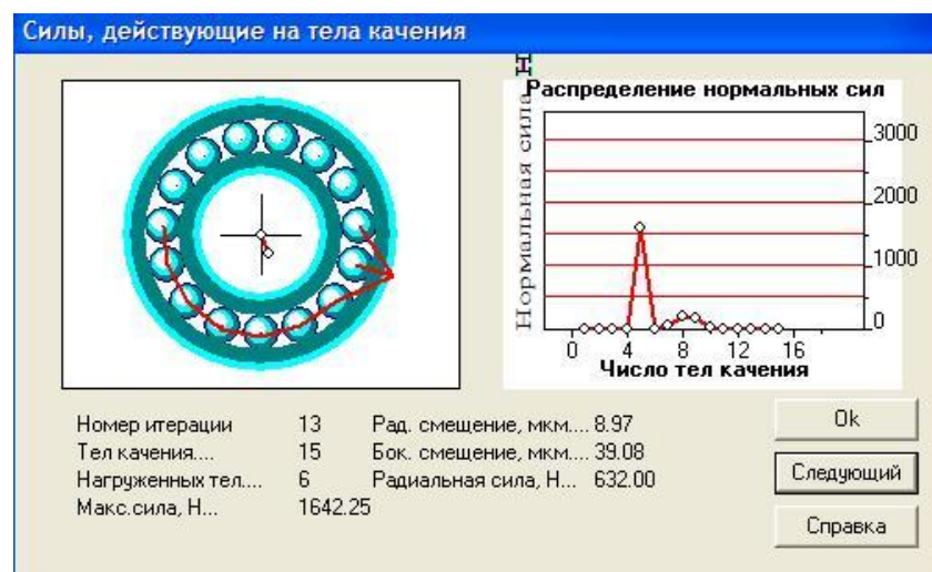
Рисунок 3.15 – Силы, действующие на подшипник 7000103
