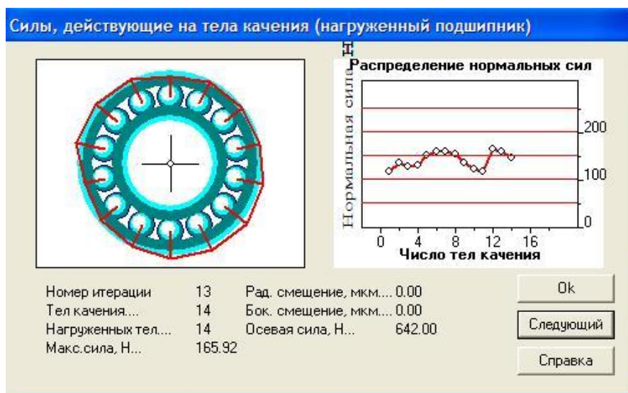
Рисунок 3.16 - Силы действующие на подшипник 36102К
