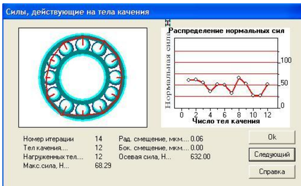
Рисунок 2.10 – Силы, действующие на подшипник 8306Н
