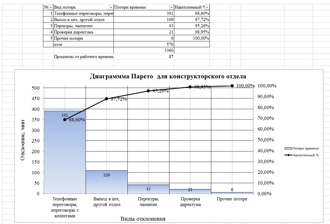
Рисунок 3.10 – Анализ Парето по скрытым потерям в конструкторском отделе.
