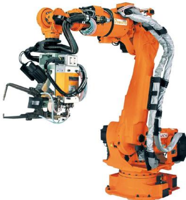
Рисунок 1.1 – Промышленный робот фирмы Nachi Robotic Systems Inc (США) для выполнения контактной сварки
