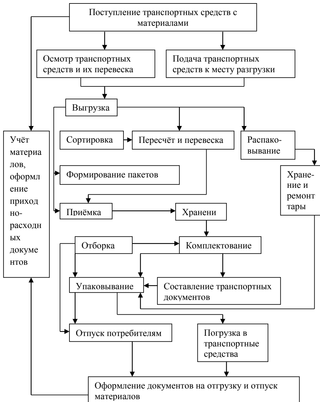
Рисунок 2 - Технологический процесс производства складских операций
