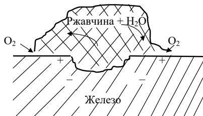
Рис. 3.4. Элемент дифференциальной аэрации на железе со ржавчиной
