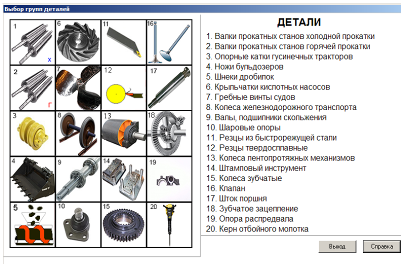
Рис. 4. Схемы различных групп деталей, подлежащих восстановлению
