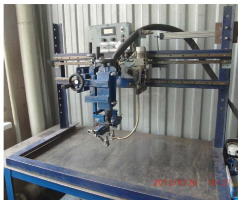
Рис. 1.5. Внешний вид портала установки для энергосберегающей дуговой сварки в среде защитных газов с пространственно-параметрическим управлением тепловложением прямолинейных швов на плоскости
