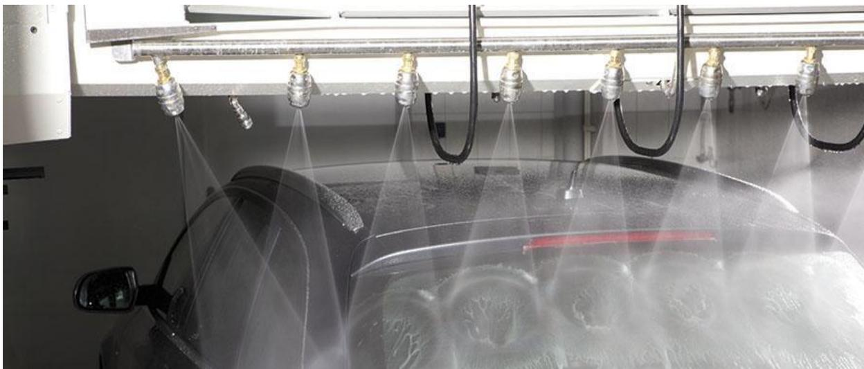
Рисунок 1.2 – Бесконтактная мойка
