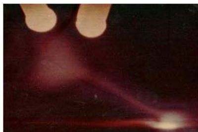
Рис. 2. Активное пятно трехфазной дуги на поверхности металла
