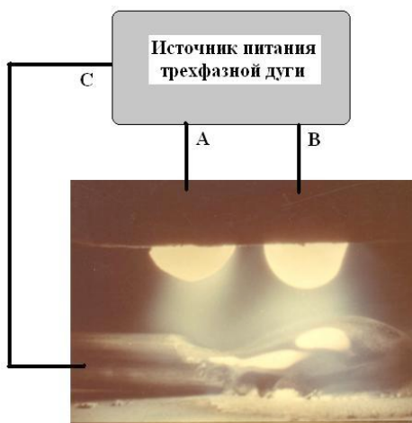
Рис. 4. Схема подключения присадочной проволоки к средней фазе трехфазного источника питания
