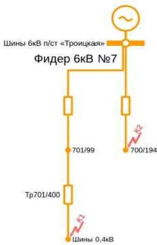
Рисунок 14 – Схема замещения фидера 6 кВ №7
