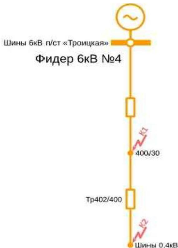
Рисунок 13 – Схема замещения фидера 6 кВ №4
