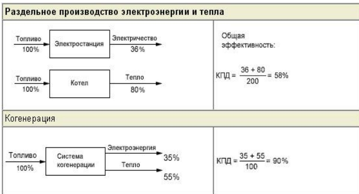
Рисунок 5.1 – КПД при различных способах выработки электроэнергии и тепла
