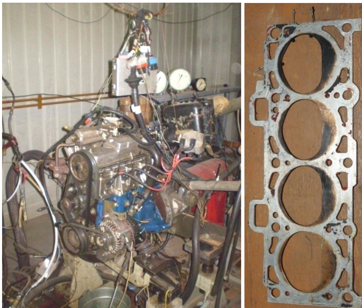
Рисунок 2.4 - Двигатель ВАЗ-2111 с распределенным впрыском топлива (а), и пластина для регулирования степени сжатия (б)
