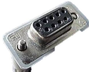
Рисунок 1.8 – Разъем последовательного COM порта интерфейса RS-232.
