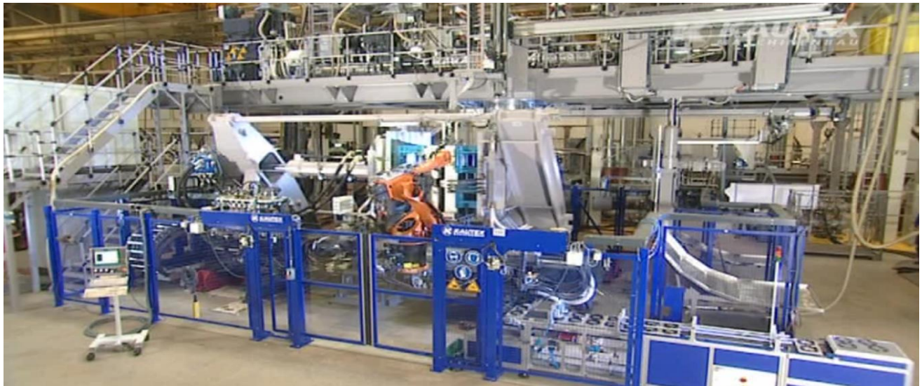
Рисунок 2.1 – Экструзивно-выдувная установка KBS 241
