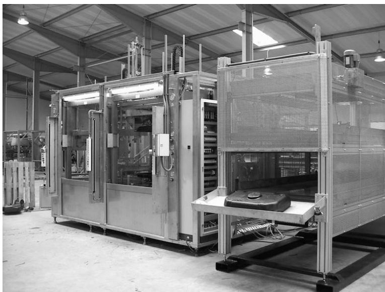
Рисунок 2.4 – Транспортная лента, соединенная с ванной охлаждения
