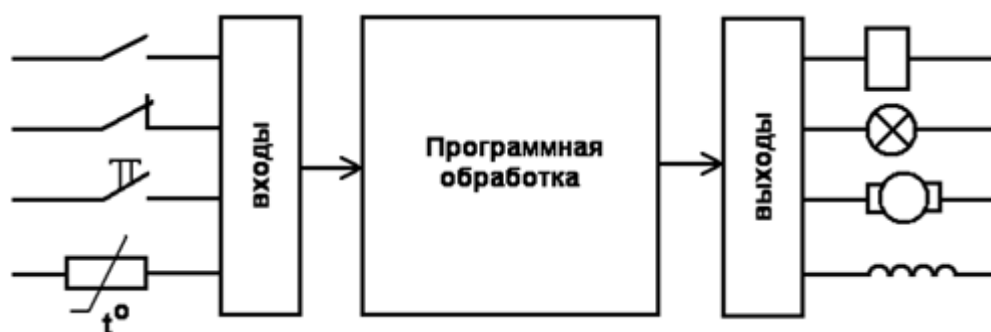
Рисунок 4.5 – Принцип работы ПЛК
