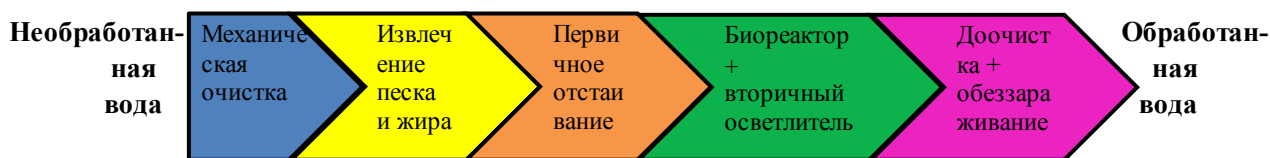
Рисунок 1 – Типичные этапы схемы очистки сточных вод
