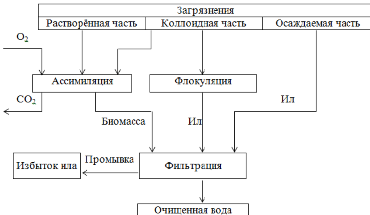
Рисунок 7 – Схема функционирования биофильтра
