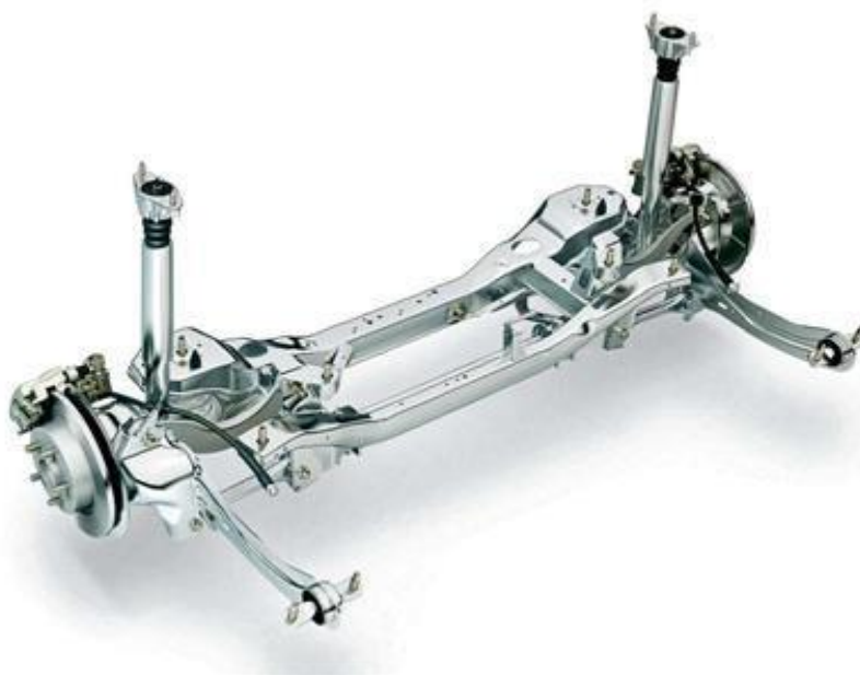
Рисунок 7 – Задняя подвеска автомобиля FordFocus
