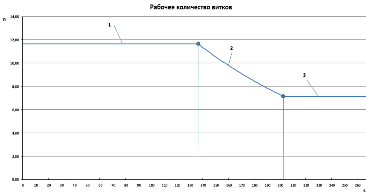
Рис. 10 – зависимость количества работающих витков от прогиба
