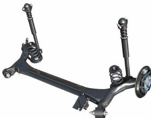
Рисунок 3 – Полузависимая подвеска автомобиля.
