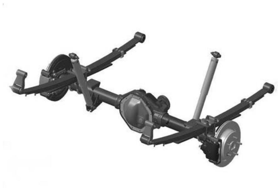
Рисунок 5 – рессорная зависимая подвеска автомобиля
