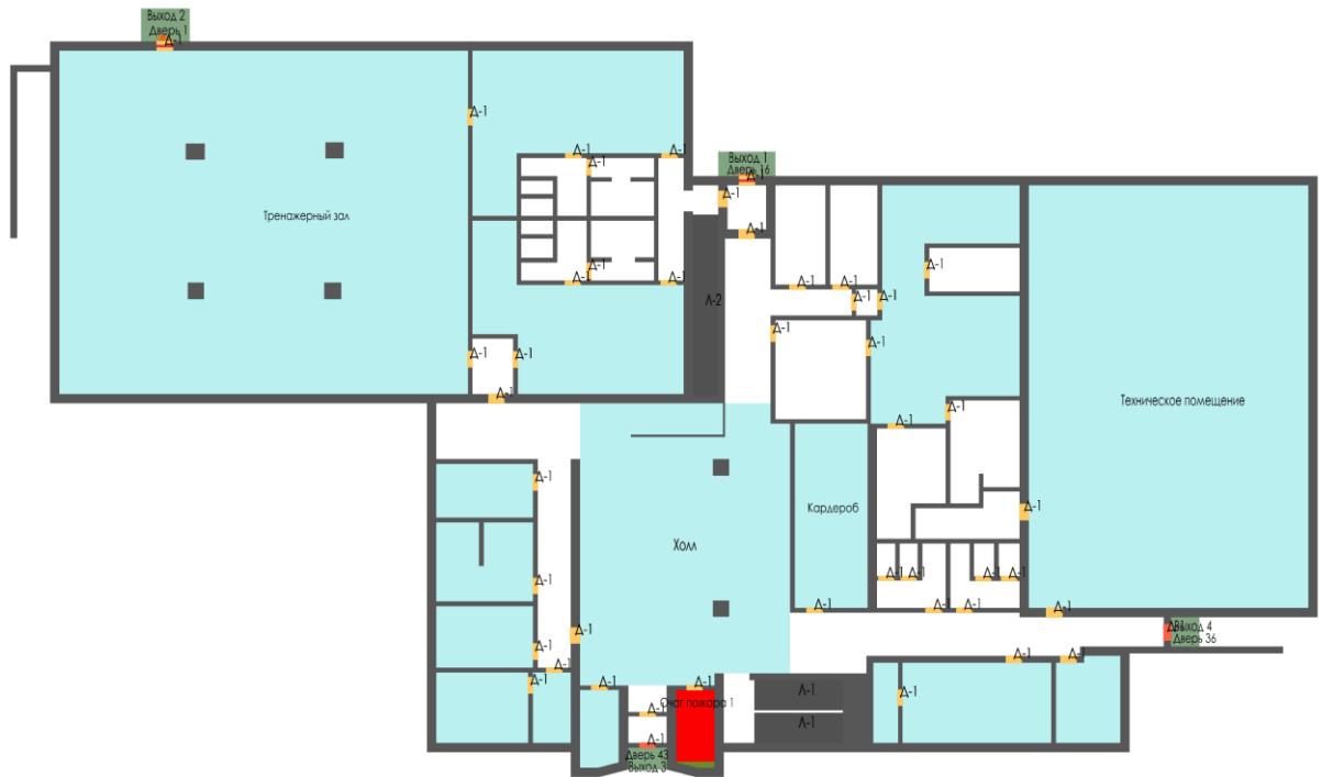
Рисунок В.5 - Этаж 1. Расположение людей через 94,6 сек. после начала пожара
