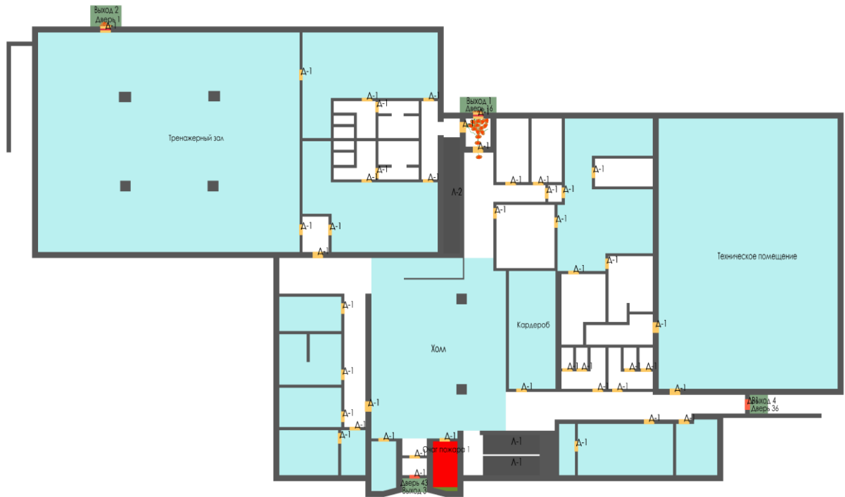
Рисунок В.3 - Этаж 1. Расположение людей через 83 сек. после начала пожара
