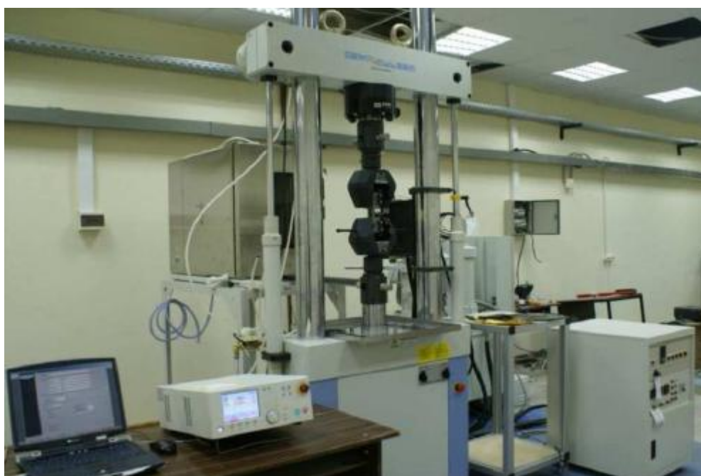
Рисунок 2.27 – Универсальная машина для осуществления статических и динамических испытаний
