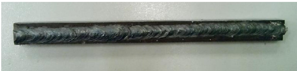
Рисунок 2.24 – Заготовка для изготовления образцов металла сварного шва
