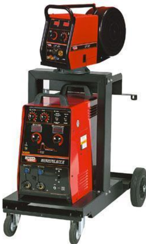
Рисунок 1.14 – Источник питания сварочной дуги Invertec STT-II, оснащённый механизмом подачи проволоки LF-33
