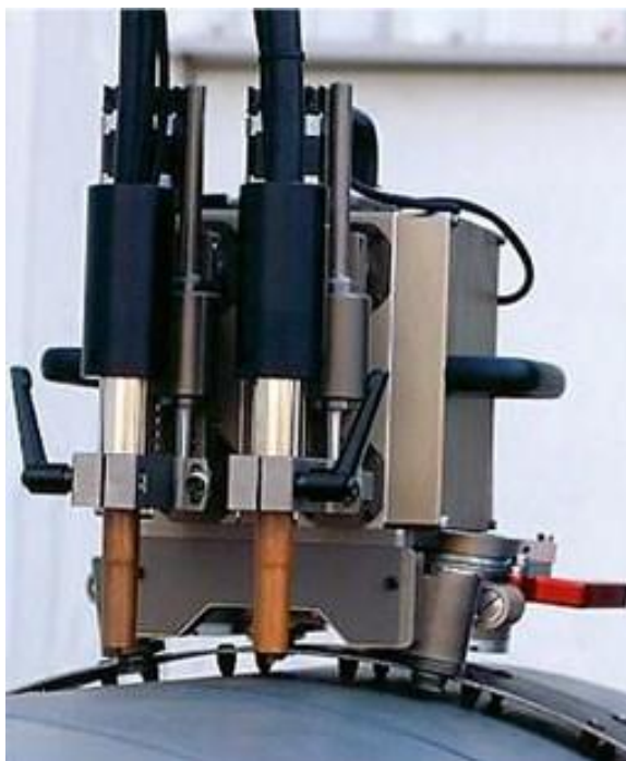
Рисунок 1.15 – Сварка с использованием двухдуговой головки Р-600
