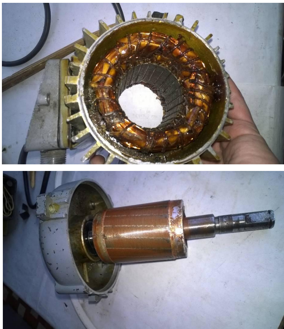
Рисунок 2.8 – Электродвигатель насоса системы охлаждения установки Квант-15 в разборе
