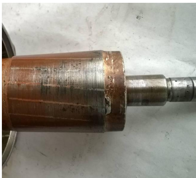
Рисунок 2.9 – Изношенное посадочное место подшипника на валу электродвигателя
