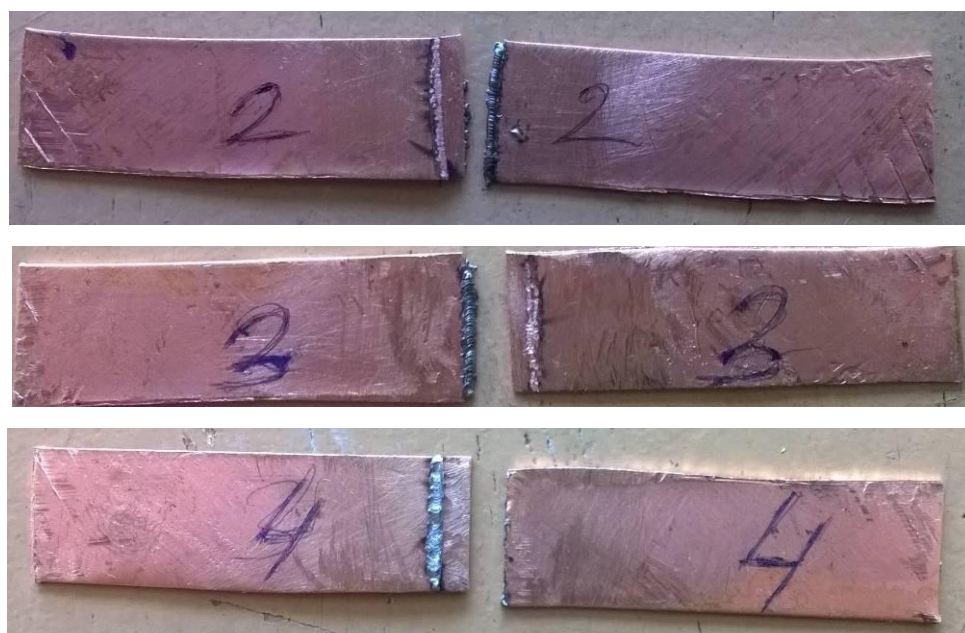
Рисунок 3.18 – Паянные образцы внахлест после испытания на прочность.
