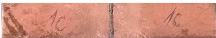
а) Образец выполненный встык
