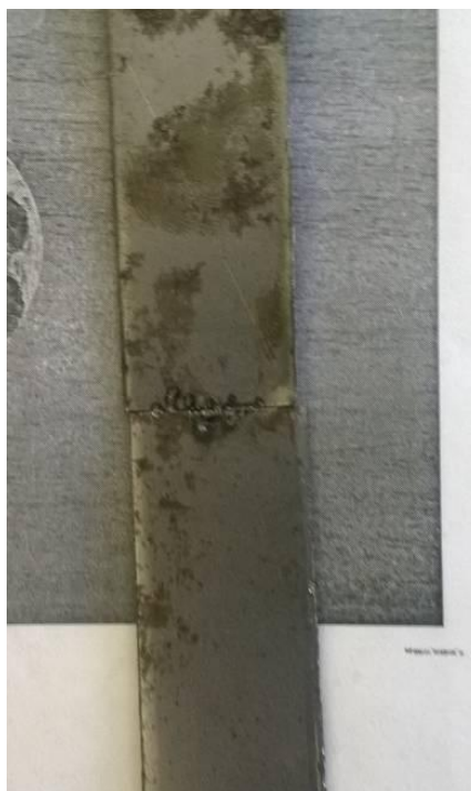
Рисунок 3.3 – Лазерная сварка образцов из Ст3 на установке Квант-15
