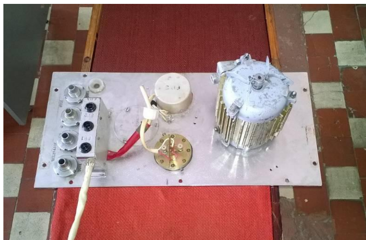
Рисунок 2.21 – Испытания электродвигателя в собранном виде насоса
