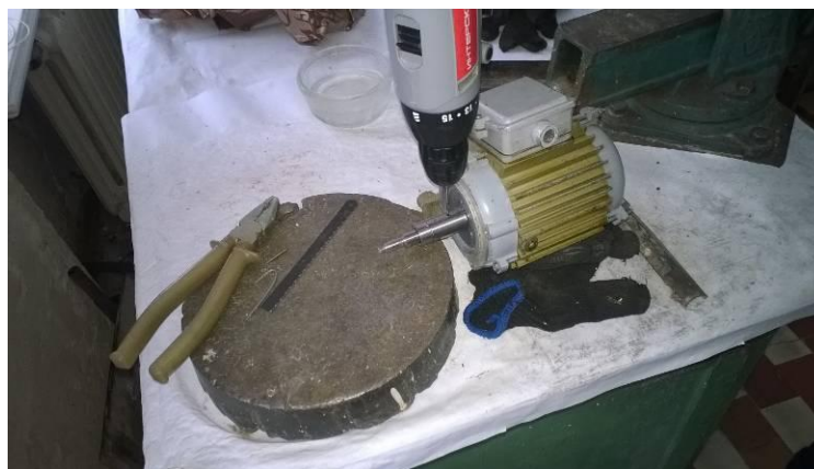
Рисунок 2.4 – Процесс высверливания шплинта промежуточного вала.
