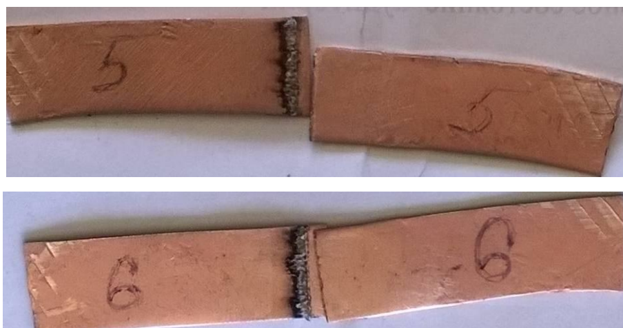
Рисунок 3.21 – Образцы, паянные внахлест после испытаний на разрыв.
