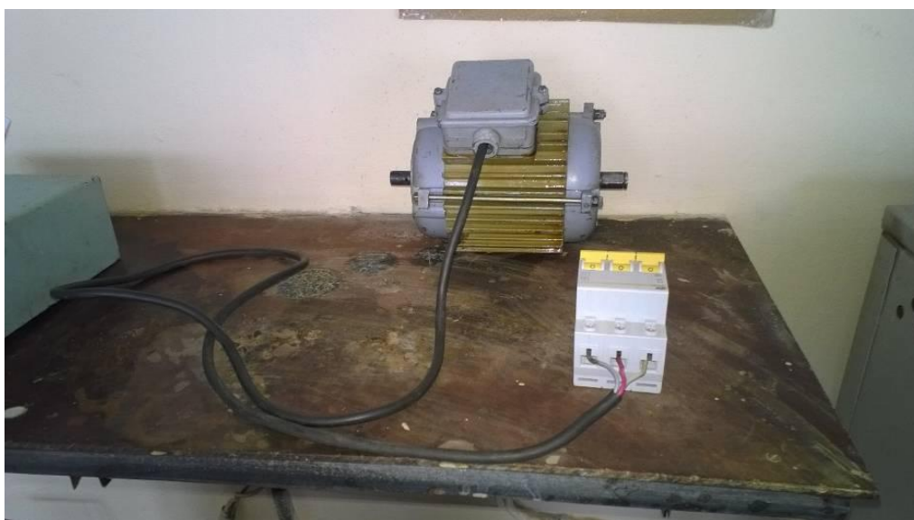
Рисунок 2.7 – Процесс тестирования электродвигателя в режиме холостого хода
