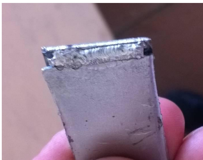
Рисунок 3.5 – Образец Ст3, паянный припоем ПОС-61 без использования флюса
