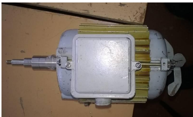
Рисунок 2.16 – Собранный электродвигатель с промежуточным валом.
