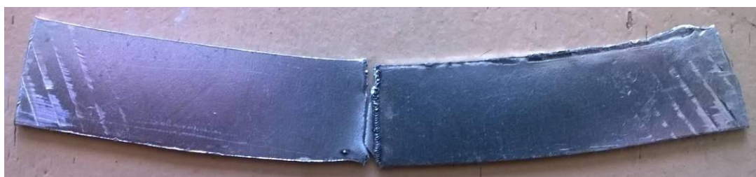
Рисунок 3.13 – Контрольный сварной образец после испытаний на разрыв.
