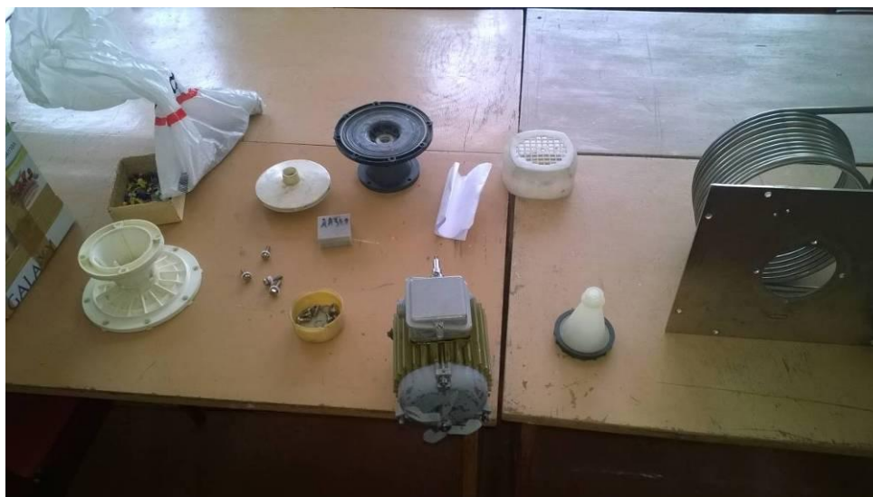
Рисунок 2.17 – Детали для сборки центробежного насоса, системы охлаждения установки Квант-15.
