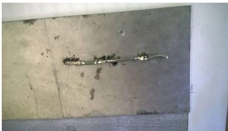
Рисунок 3.4 – Образец из Стали08Ю с расплавленным припоем ПОС-61
