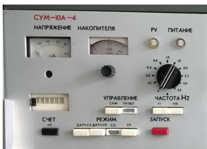
Рисунок 3.1 – Пульт управления СУМ-10А-4 на СПИК-3 с установленными режимами
