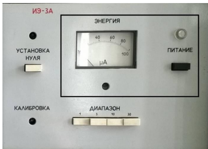
Рисунок 1.20 – ИЭ-3А индикатор энергии импульса лазера
