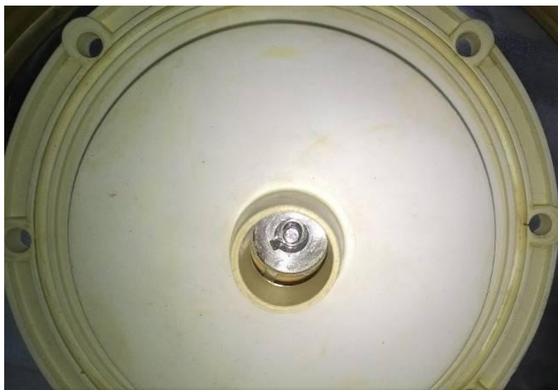
Рисунок 2.19 – Утопленная резьба промежуточного вала, не полностью насаженная крыльчатка
