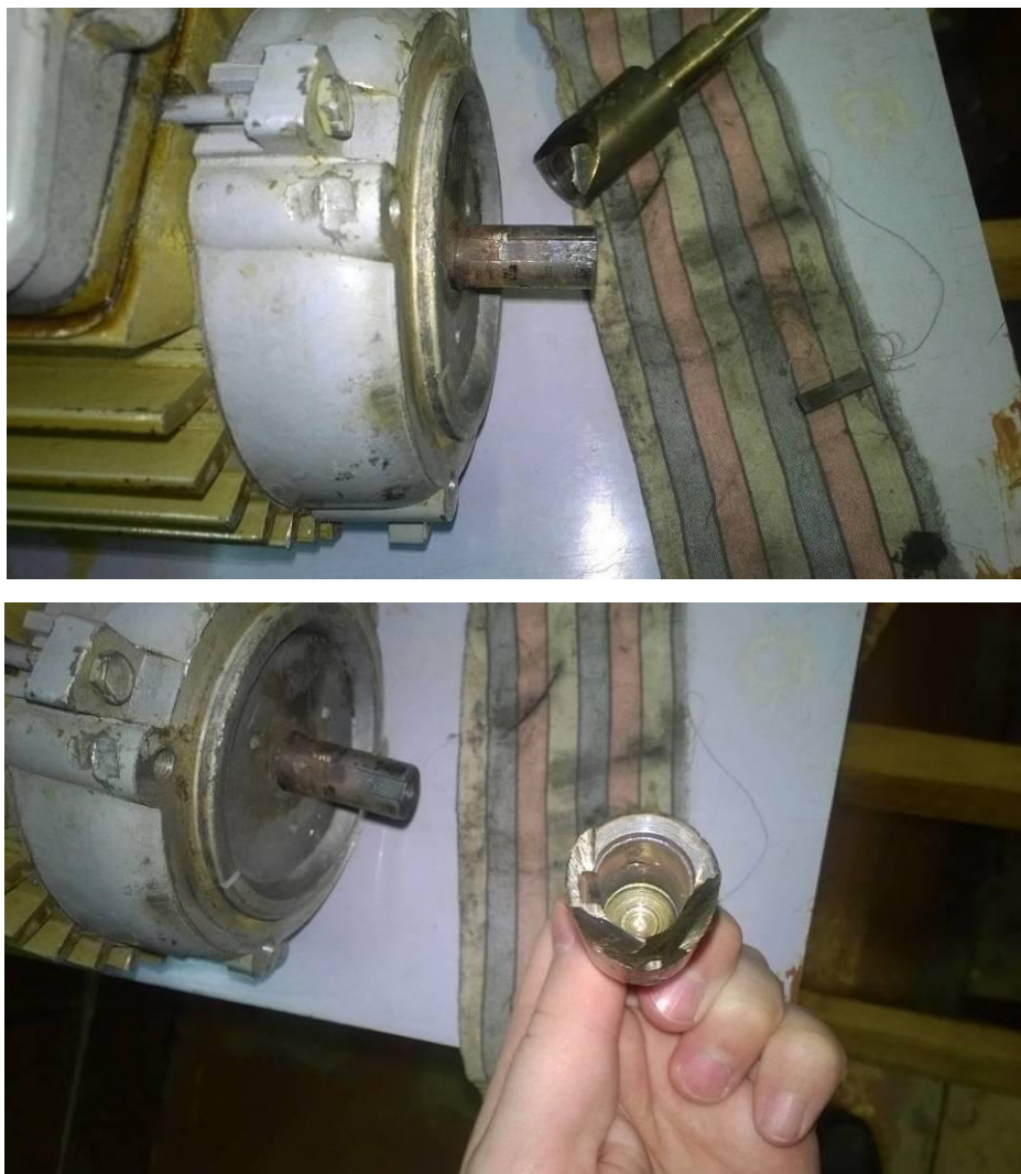
Рисунок 2.6 – Промежуточный вал после снятия с электродвигателя
