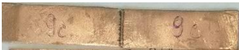
Рисунок 3.28 – Образец с комбинированным паяным соединением
