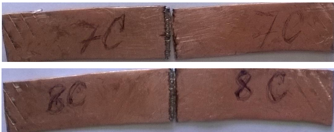
Рисунок 3.23 – Паяные соединения встык после испытаний на разрыв
