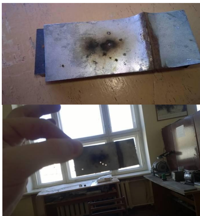
Рисунок 3.2 – Результат подачи мощного сфокусированного импульса на сталь 0.8Ю
