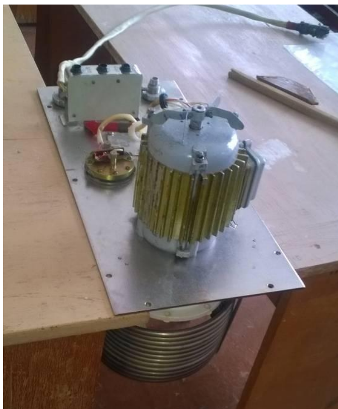
Рисунок 2.18 – Электродвигатель и корпус насоса, установленные на крышку бочка системы охлаждения установки Квант-15.
