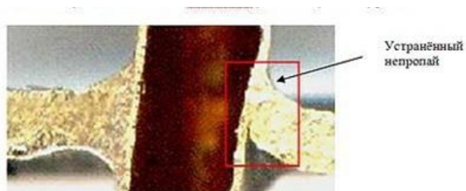
Рисунок 1.17– а) поперечное сечение непропая радиаторной трубки [15]
