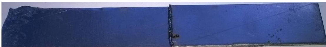
Рисунок 3.12 – Контрольный сварной образец
