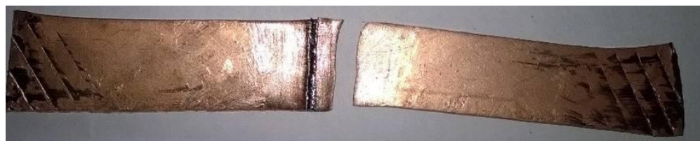
а) Образец нахлесточного соединения
