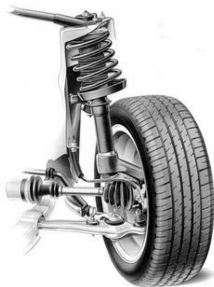
Рисунок 1.2 – Передняя подвеска типа «Мак Ферсон»
