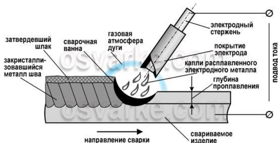
Рисунок 1.3 – Схема сварки штучными электродами
