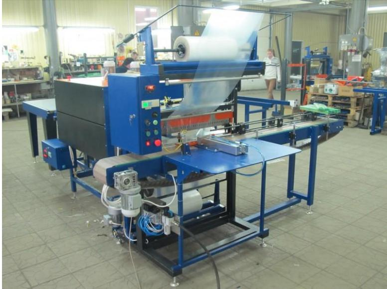
Рисунок.2.12 - Станок вакуумной запайки готовой продукции
