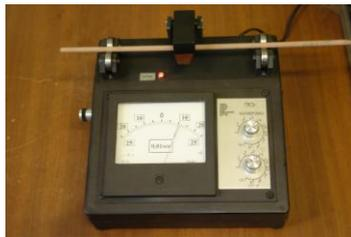
Рисунок.2.10 - Прибор контроля эксцентрики
