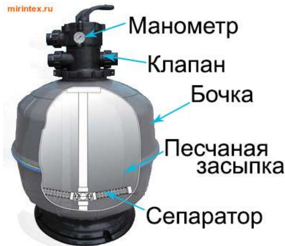
Рисунок 2.10 – Устройство песчаного фильтра
