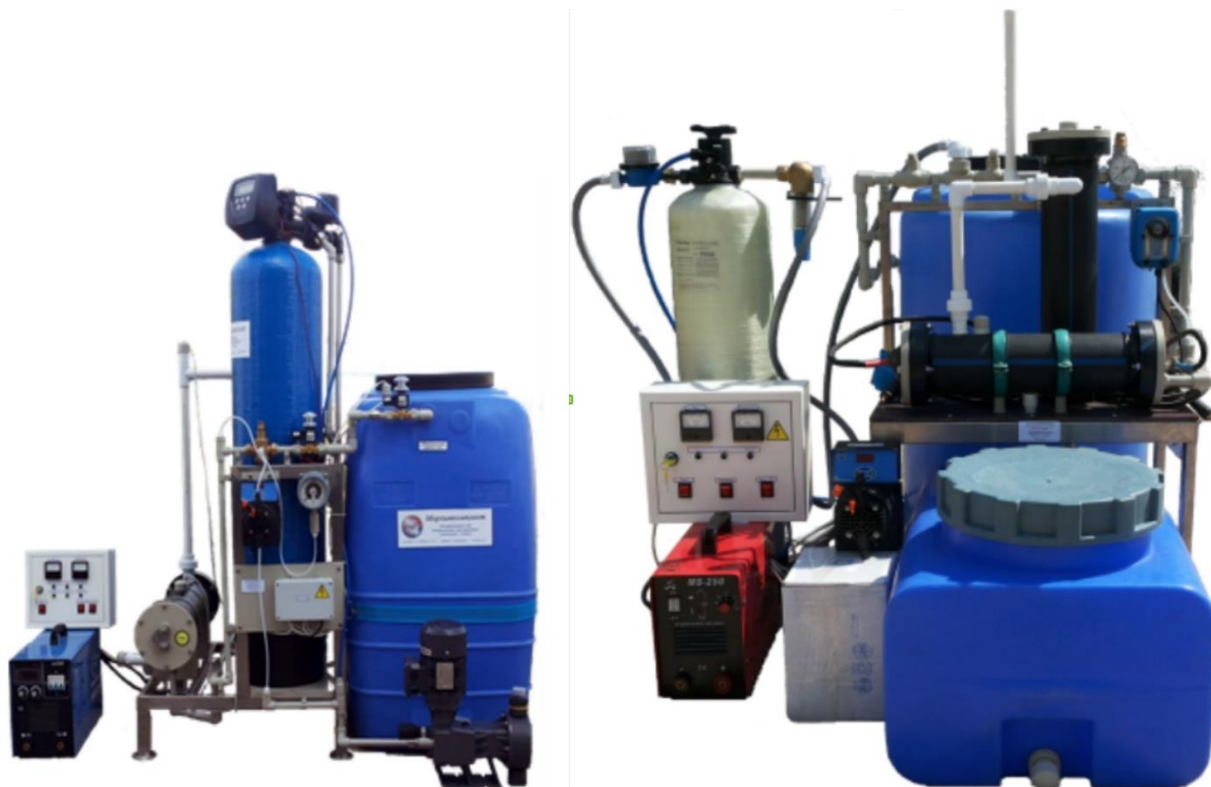
Рисунок 2.5 – Установки приготовления растворов ГПХН и ГПХК
