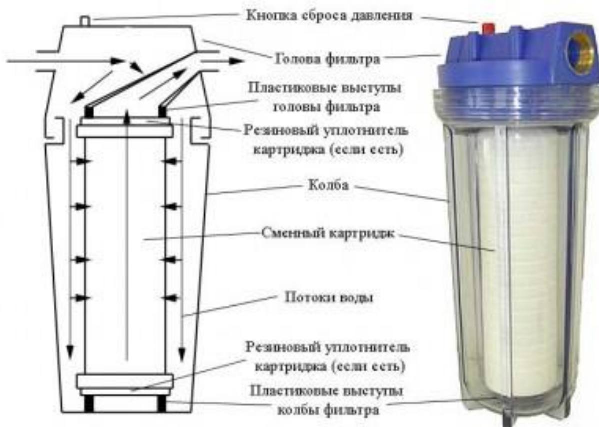
Рисунок 2.18 – Устройство картриджного фильтра
