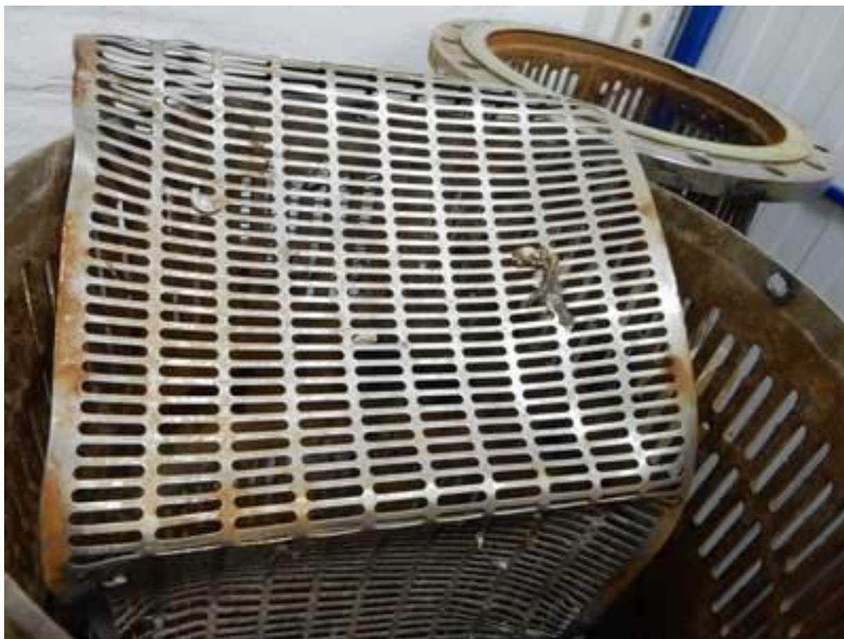
Рисунок 2.28 – Ракушки и скелет рыбы на деформированной решётке
