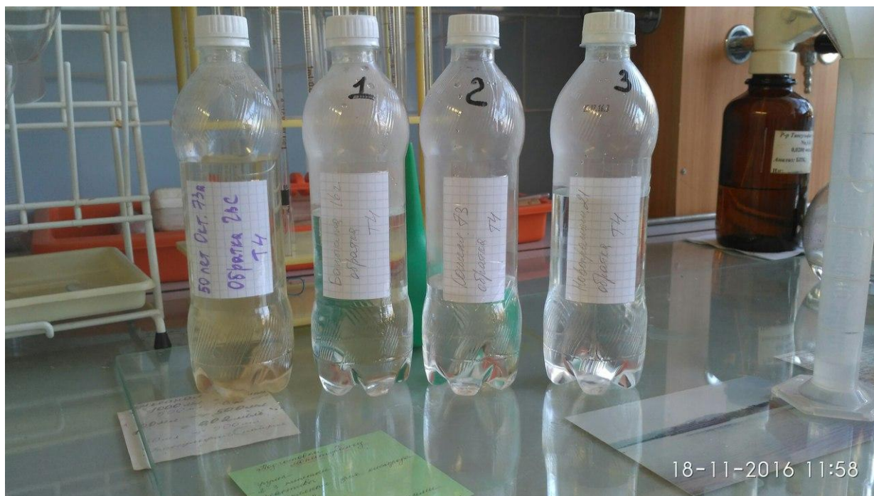
Рисунок 2.28 – Пробы воды, взятые на циркуляционном трубопроводе Т4 на принципиальной схеме до теплообменника
