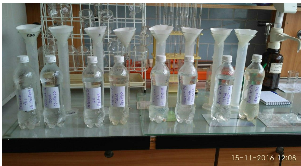
Рисунок 2.27 – Пробы воды, взятые со сбросных кранов на трубопроводе В1 на принципиальной схеме до прибора ГМС, после прибора ГМС перед теплообменником
