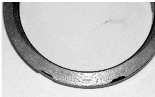
Рис. 2.7. Вид эрозионно-механического износа торцового уплотнения
