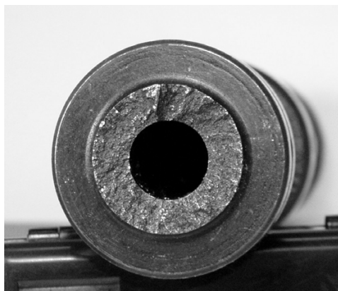
Рис. 2.1. Излом вала, возникший при расклинивающем действии присадки
