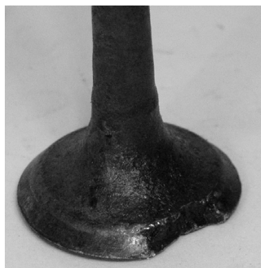
Рис. 2.6. Вид эрозионных повреждений клапана
