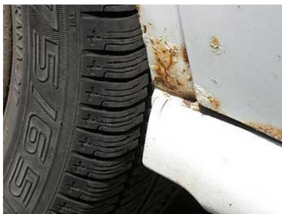
Рис. 3.27. Вид коррозионных повреждений кузова автомобиля
