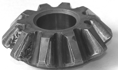
Рис. 3.11. Питтинг боковых поверхностей зубьев шестерни
