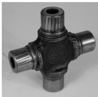
Рис. 3.21. Фреттинг-коррозия цапф крестовины
