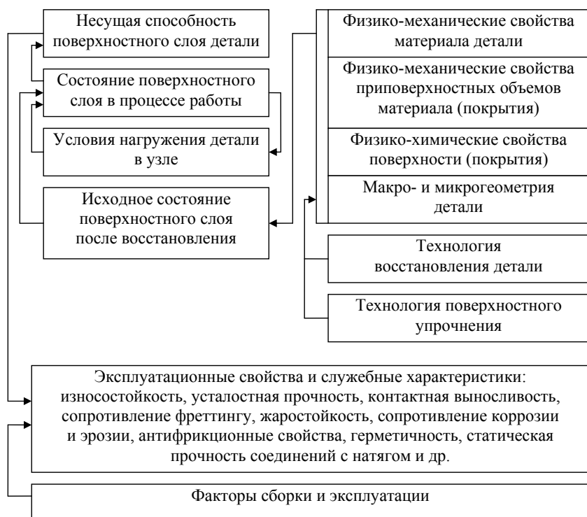
Рис. 1.1. Схема обеспечения эксплуатационных свойств путем управления несущей способностью поверхностного слоя
