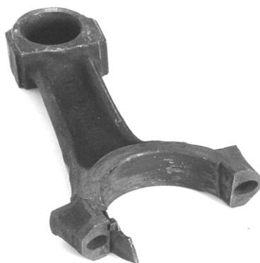
Рис. 2.5. Шатун, деформированный при схватывании поршня
