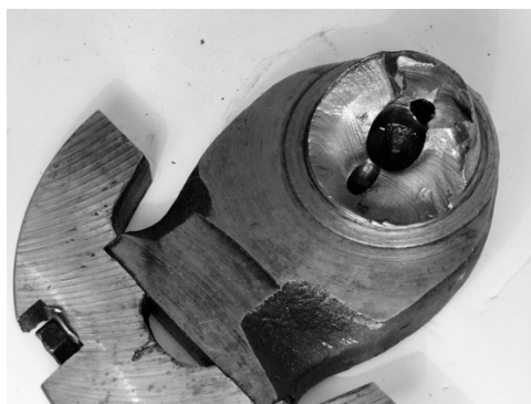
Рис. 2.3. Вид усталостного излома коленчатого вала
