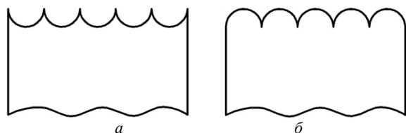
Рис. 3.4. Различная форма шероховатости при равных высотно-шаговых характеристиках
