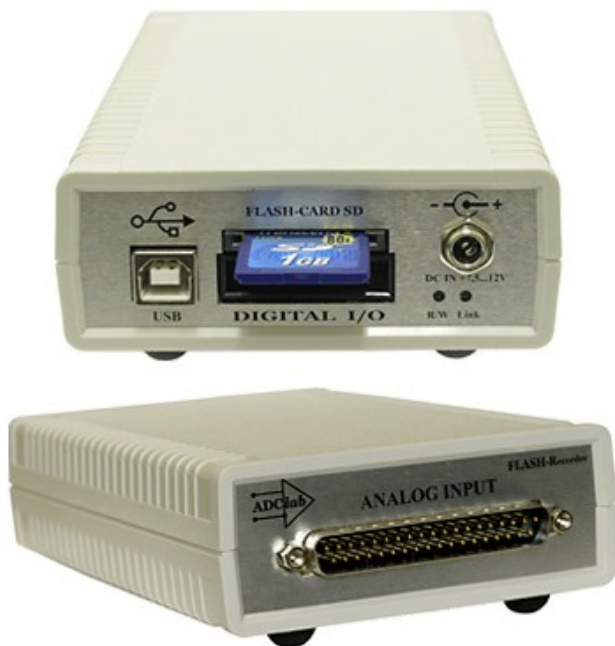
Рис. 4.6. Внешний вид и коммутационный разъем регистратора «S-Recorder»
