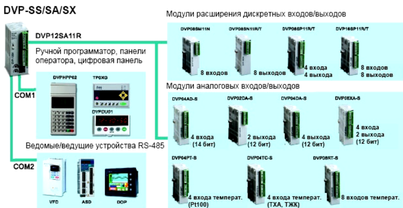
Рис. 4.14. Подключение контроллеров на примере оборудования Delta Electronics
