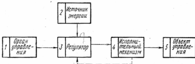
Рис. 12.2. Функциональная схема следящего привода
