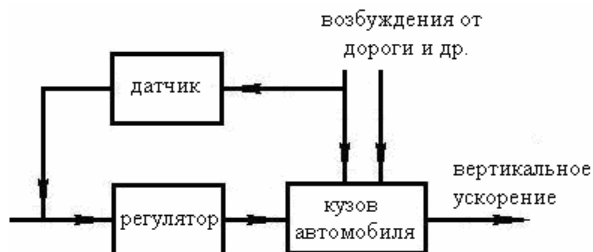
Рис. 11.2. Пример функциональной схемы регулируемой подвески автомобиля
