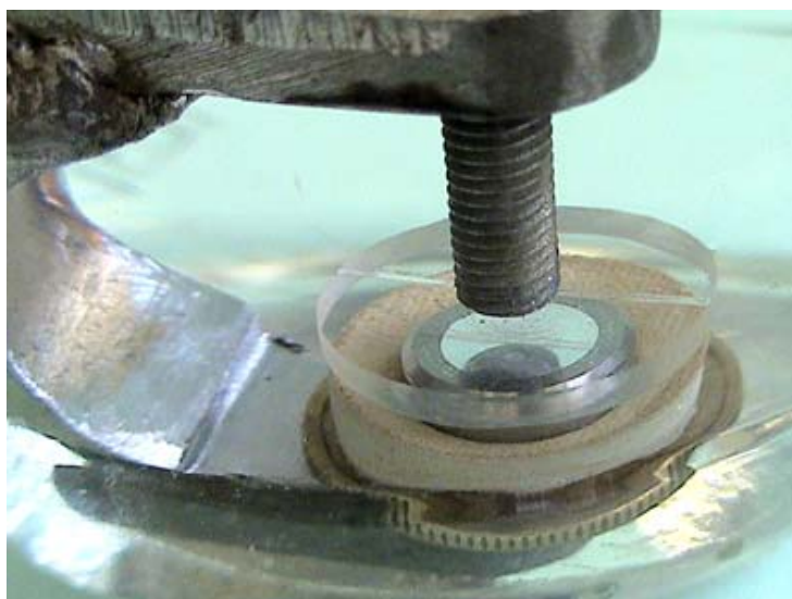
Рис. 16. Приспособление для проверки герметичности вакуумно-жидкостным методом (ВЖМ) с ограничением деформации мембраны при вакуумировании корпуса
