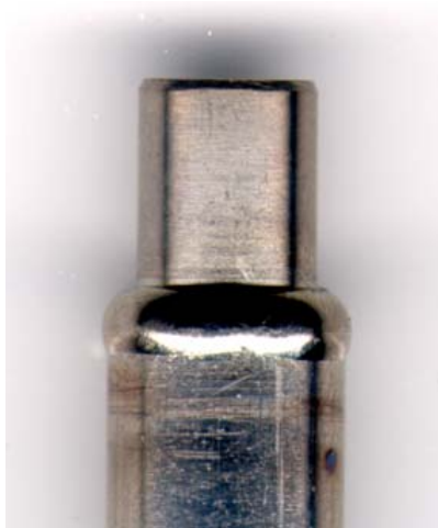
Рис. 22. Образец сварного соединения, выполненного на установке электронно-лучевой сварки ЭЛУ-5
