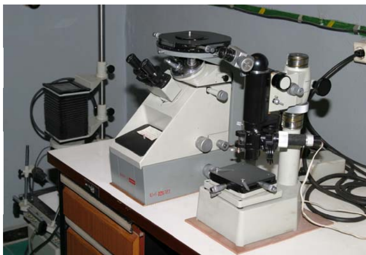
Рис. 6. Участок металлографических исследований, оснащенный микроскопом ММР-4 и микротвердомером ПМТ-4
