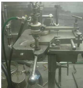
Рис. 8. Внешний вид и схема компоновки оборудования для дистанционной аргонодуговой сварки методом оплавления торца: 1 – изделие; 2 – сварочная головка; 3 – защитный бокс; 4 – система подачи защитного газа; 5 – источник питания
