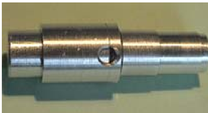
Рис. 14. Кондуктор для сборки и центровки мембраны с элементами корпуса источника с окнами для выполнения трех прихваток первого шва
