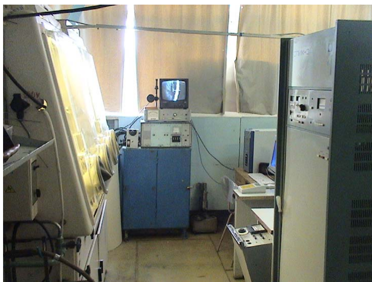
Рис. 15. Участок лазерной сварки на базе установки КВАНТ-15 с СМПЛИ в вытяжном шкафу
