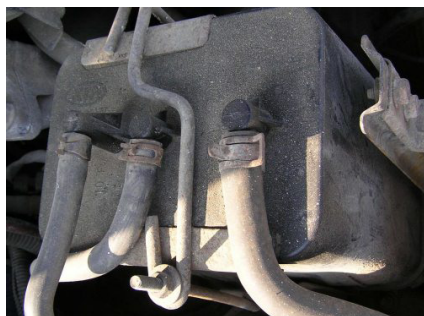
Рис. 55. Съемный фильтр ресивера в месте установки под капотом
