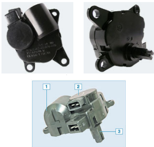
Рис. 35. Микро-мотор-редуктор заслонки отопителя: 1 – микро-мотор-редуктор; 2 – датчик положения заслонки; 3 – выходной вал
