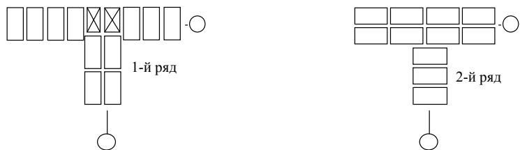
Рис. 15. Кладка примыканий стен толщиной в 1 кирпич
