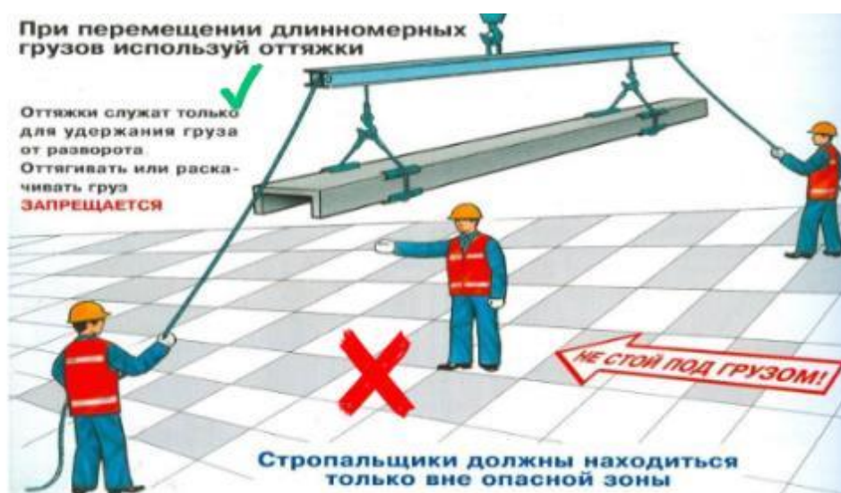
Рисунок 11 – Подъем, перемещение и транспортирование длинномерных грузов
