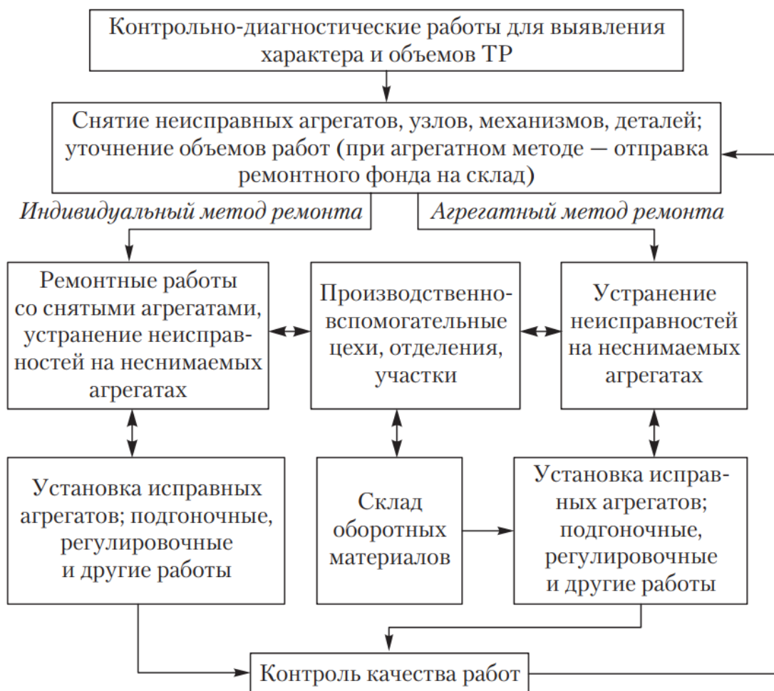
Рисунок 1 – Основной предлагаемый алгоритм производственного цикла для применения на новой ремонтной автобазе АО «АВТОВАЗ», г. Тольятти
