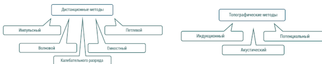
Рисунок 5 – Методы обнаружения неисправностей повреждений в кабельных линиях
