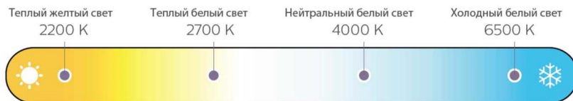
Рис. 25. Пример температурного режима осветительных приборов ( https://profgbo.ru/lighting/o-cvetovoj-temperature-svetodiodnyh-lamp-tablica-cvetnosti-markirovki-izdelij.html )
