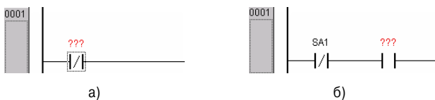
Рис. 3.3. Создание нормально замкнутого (а) и разомкнутого (б) контактов
