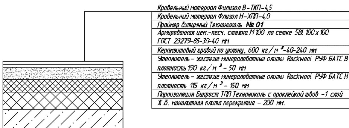
Рисунок 2 – Конструкция покрытия
