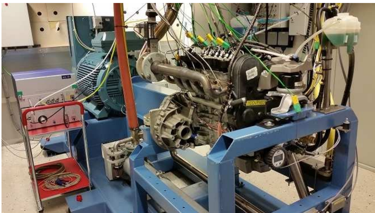
Рисунок 4 – Лабораторный двигатель. Двухтопливный дизельный двигатель, работающий на сжатом природном газе
