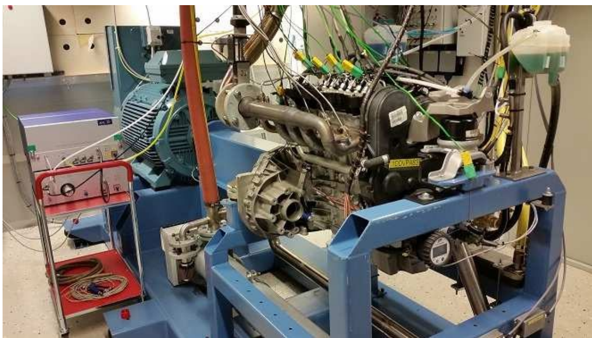
Рисунок 9 – Лабораторный двигатель. Двухтопливный дизельный двигатель, работающий на сжатом природном газе
