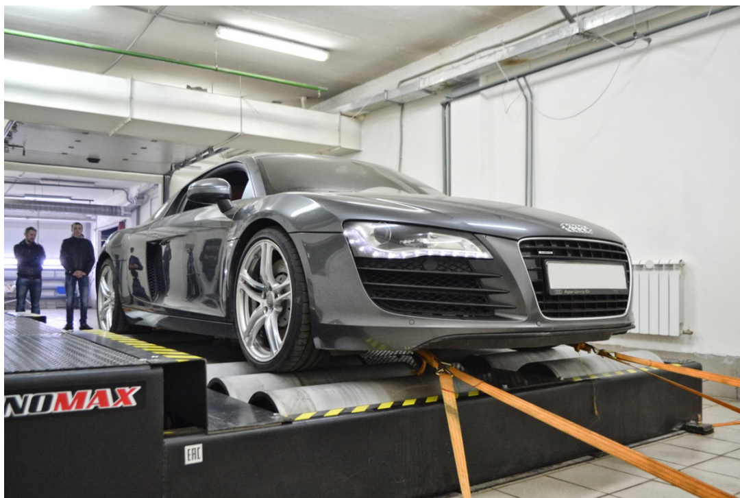
Рисунок 14 – Фиксация автомобиля стопорными ремнями
