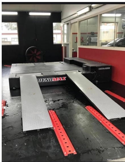
Рисунок 1 – Мощностной стенд инерционного типа для легковых автомобилей DYNOMAX 4000 AWD BR
