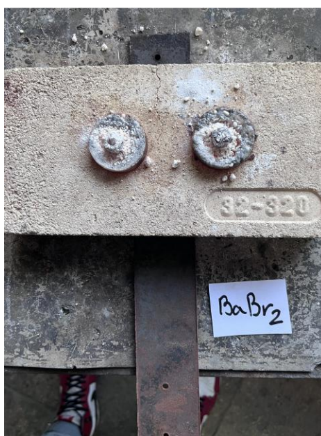
Рисунок 12 – Образцы солей после взаимодействия с расплавом магния при 800^{\circ}C
