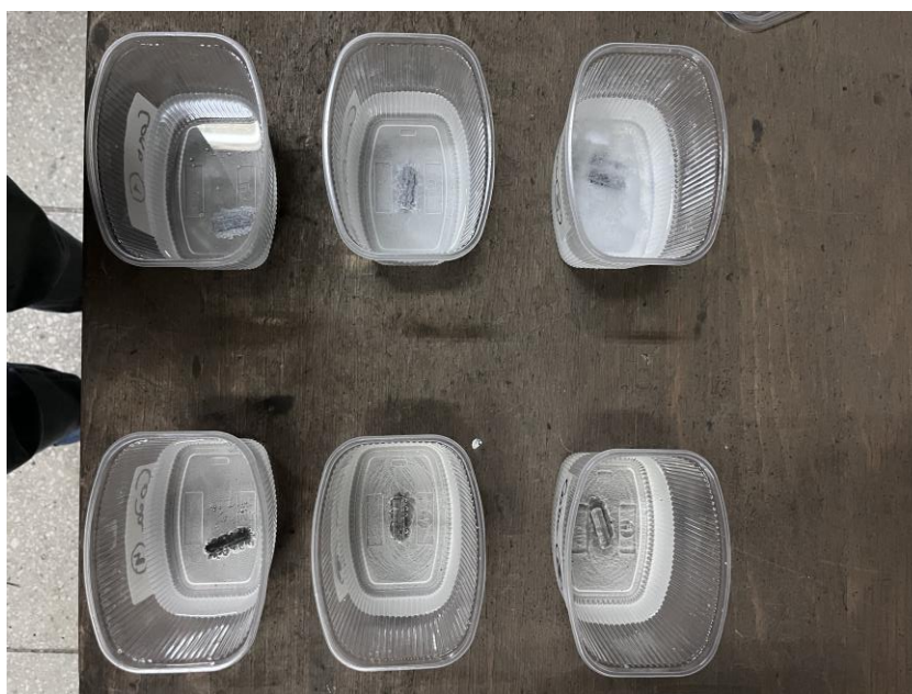
Рисунок 1 – Образцы из солей гранул с навеской из магния и с флюсом ВИЗ
