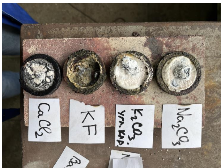
Рисунок 12 – Образцы солей после взаимодействия с расплавом магния при 800^{\circ}C
