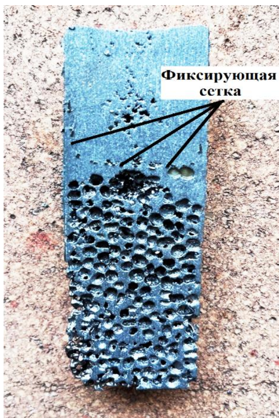
Рисунок 37 – Образцы пористого магния, полученные с вибрационной обработкой и с фиксирующей сеткой
