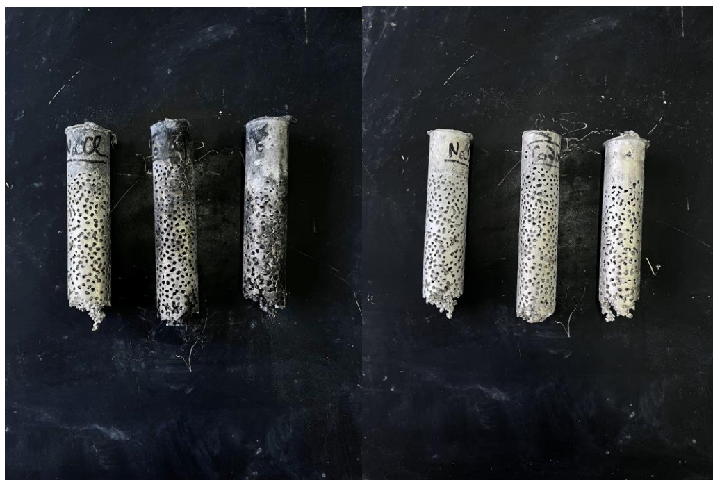
Рисунок 28 – Образцы пористого магния: а) после выщелачивания; б) после обработки в растворе уксусной кислоты
