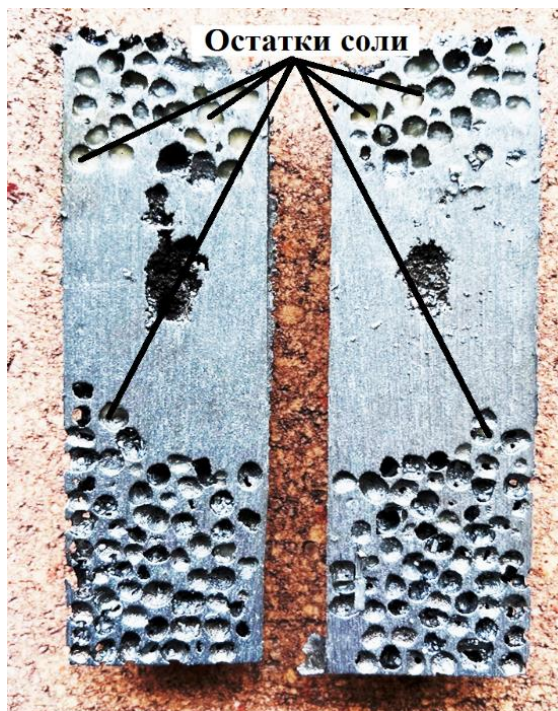
Рисунок 33 – Образцы пористого магния, полученные с вибрационной обработкой
